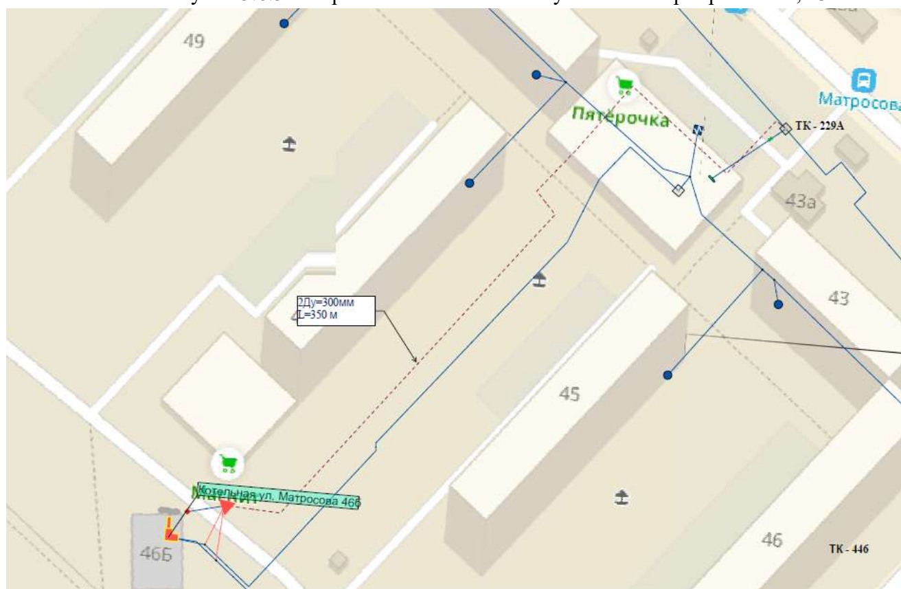
Рисунок 5.6.4 – Переключение котельной ул. Матросова, 46б
