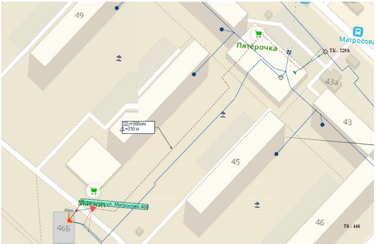
Рисунок 4.1.2.4 – Переключение котельной ул. Матросова, 466
