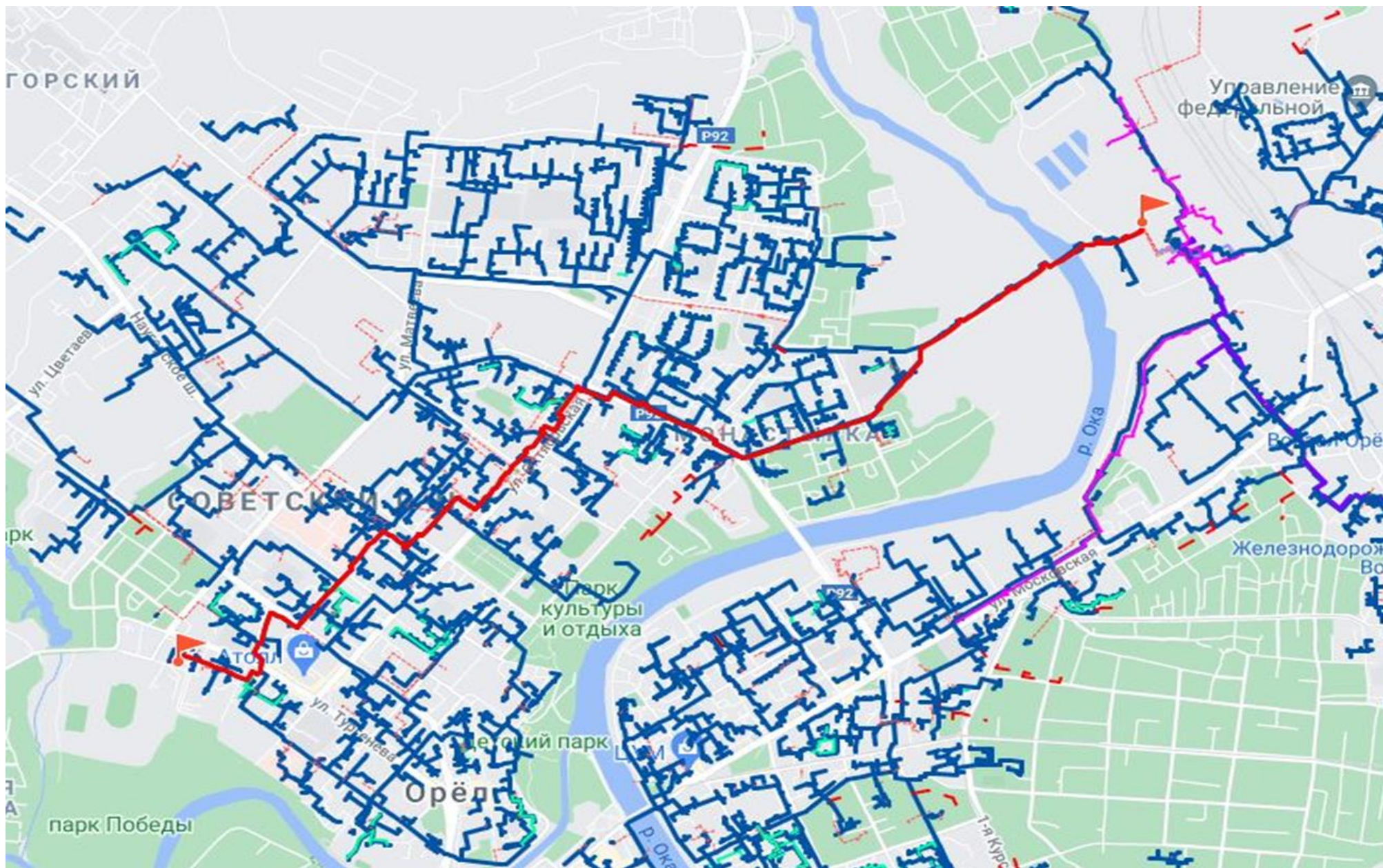
Рисунок 1.3.8.4 – Путь пьезометрического графика для участка тепловой магистрали ТМ-2 от ПП «Орловская ТЭЦ2»
