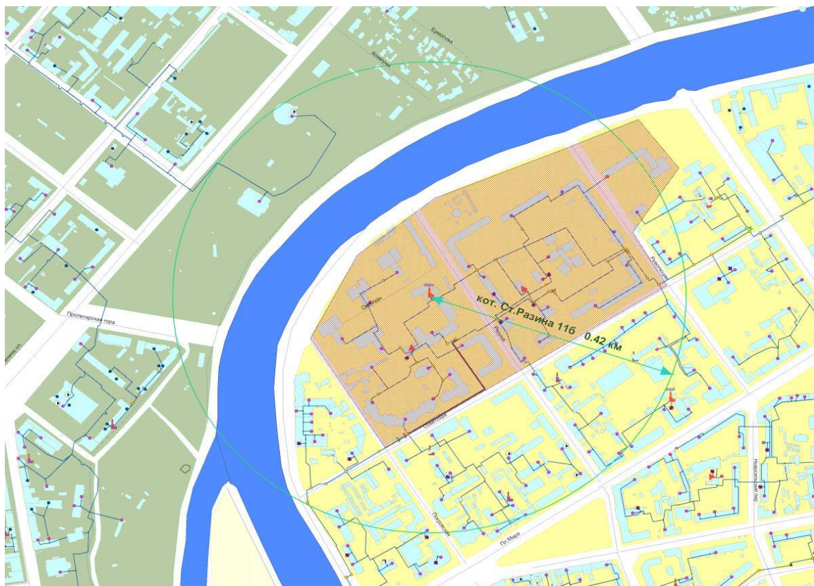
Рисунок 2.1.6. – Радиус эффективного теплоснабжения котельной ул.Степана Разина, 116
