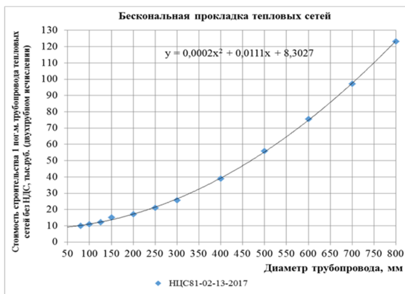
Рисунок 9.2.1 – Зависимость стоимости строительства трубопроводов тепловых сетей от диаметра трубопроводов при бесканальной прокладке
